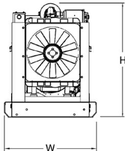
**ОТКРЫТАЯ УСТАНОВКА (включает гибкую выхлопную трубу)**
